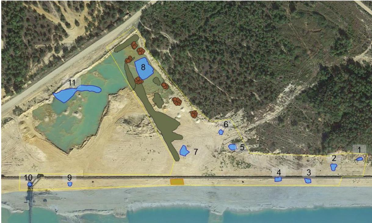
**Abb. 18:** Artenschutzfläche (gelb umrandet) mit Kleingewässeranlage (blau, Nr. 1-11) und Gestaltung des Landlebensraumes (braun: Mineralhaufen teilweise der Erdaushub von der Gewässeranlage, teilweise aus unterschiedlichem Eigenmaterial aufgefüllt). Im unteren Bildabschnitt ist die ungefähre Uferlinie eingezeichnet, in Orange die Rampe (Quelle Luftbild: gisinfo.de).
