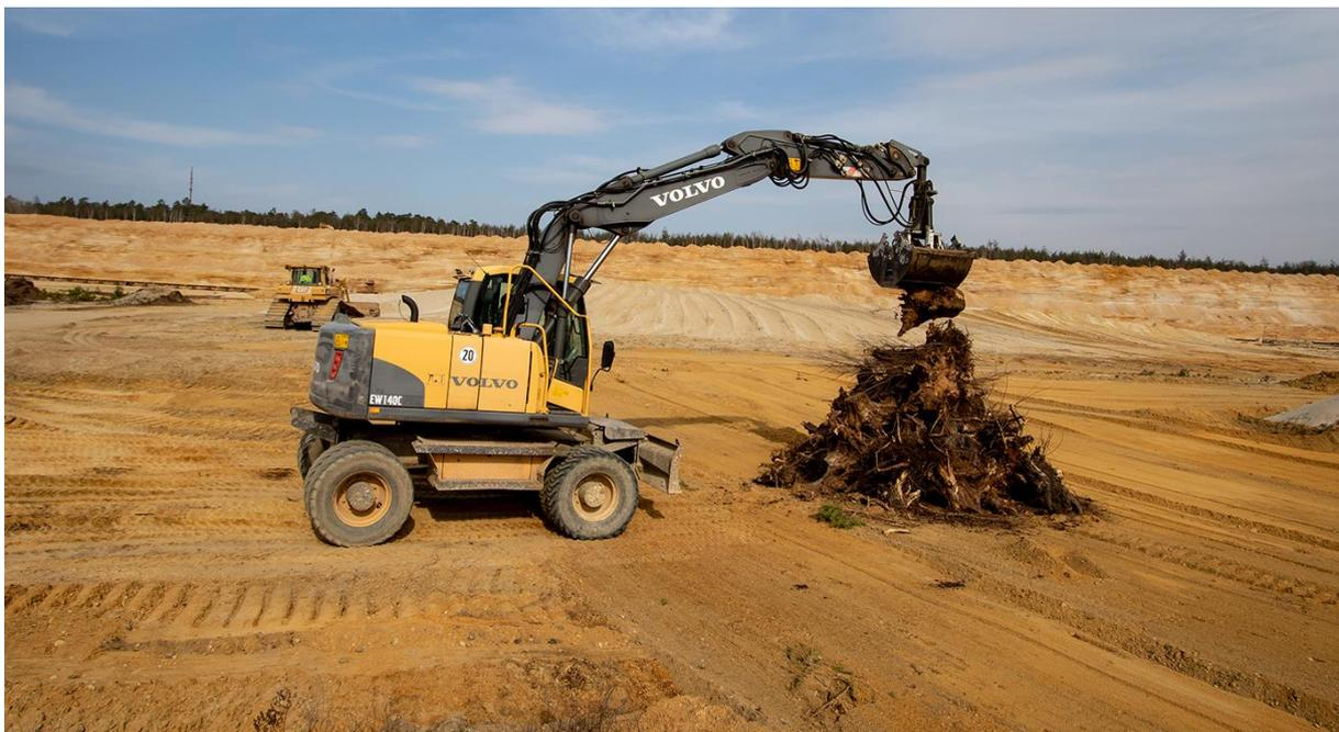
**Abb. 8:** Wurzelstubben werden sorgsam zu zwei Haufen aufgeschichtet.
