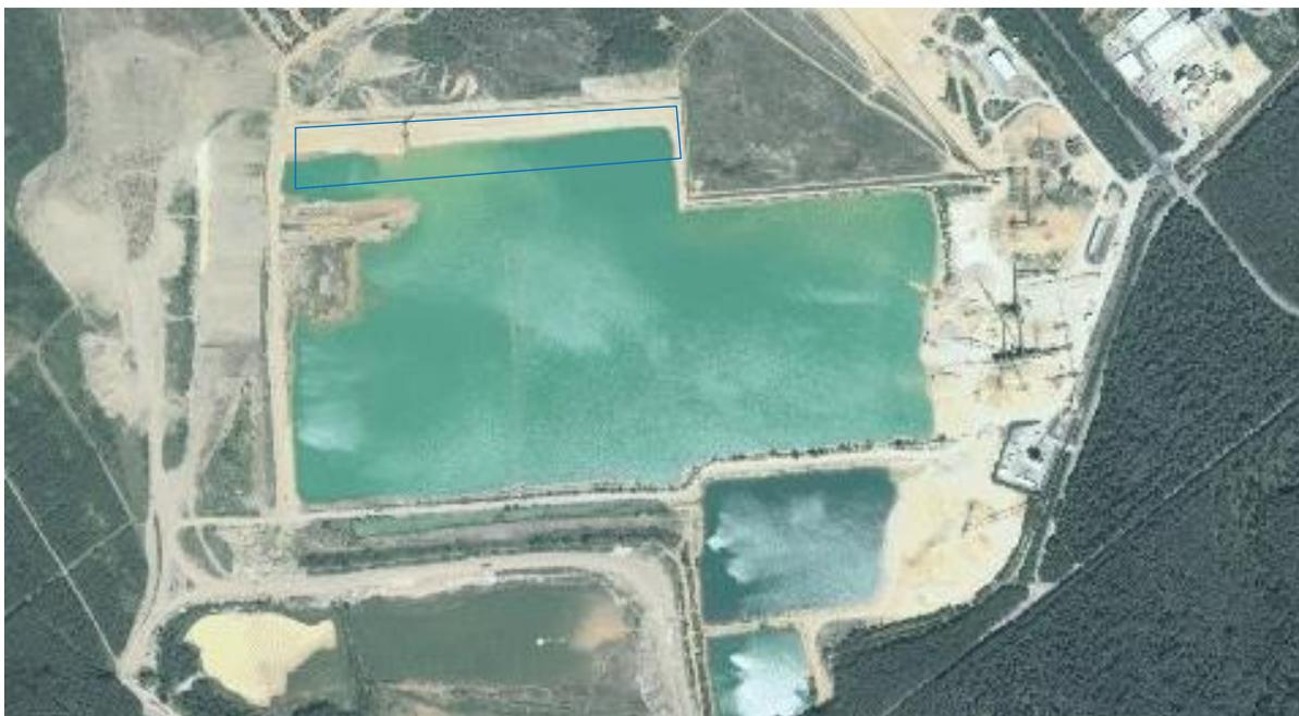
**Abb. 12:** Die Uferoptimierung mit Einrichtung einer Flachwasserzone erfolgte im Bereich der blau umrahmten Fläche (Quelle Luftbild: GisInfo.de).
