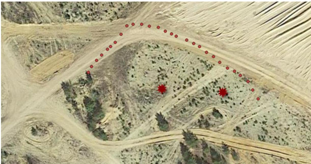
**Abb. 9:** Die fertig vorbereitete Fläche mit Wurzelstubben als Begrenzung (kleine Punkte) und sorgsam zu zwei Haufen aufgeschichtet (Sterne).
