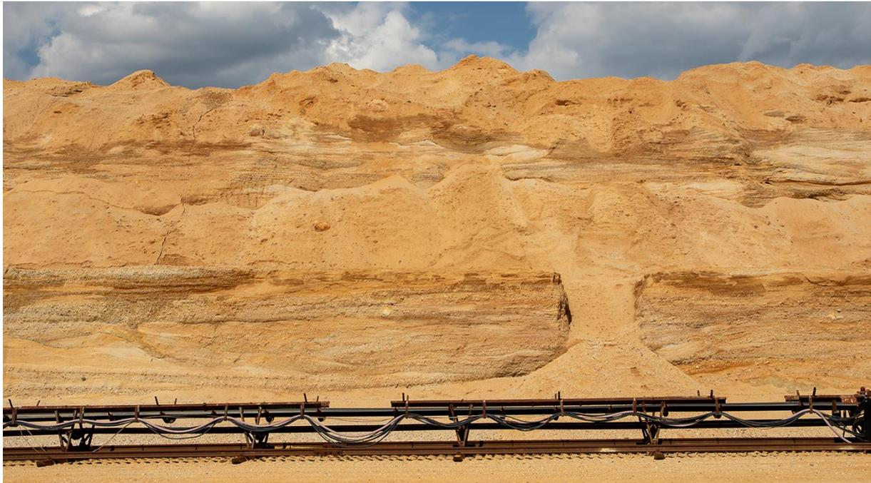
**Abb. 4:** Böschungsabschnitte werden abgeschrägt, um sie für die Uferschwalbe unattraktiv zu machen.
